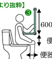
① 出入口は体を支えられる縦手すり、② 廊下は移動用の横手すり、③ トイレは立ち上がりと座位を保持するL型手すりをそれぞれ図示した寸法で設置することをお勧めします。
